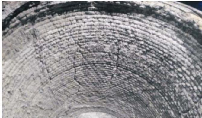
Рисунок 1 – Вертикальные трещины в периклазоуглеродистой футеровке сталеразливочного ковша
