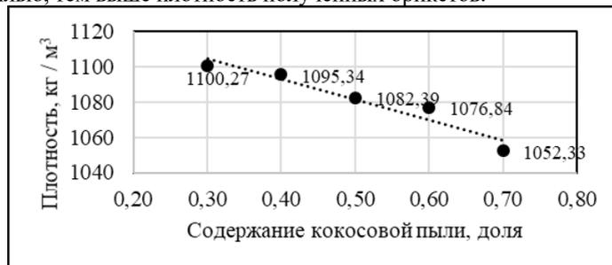
Рисунок 1 – Зависимость плотности брикетов от содержания коксовой пыли
