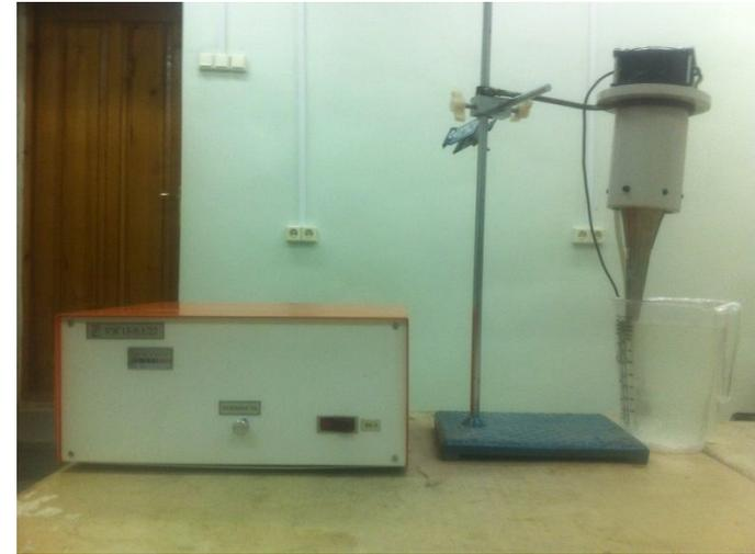
1 – сурет УЗД 2-0.1/22 зертханалық ультрадыбыстық диспергатор
