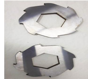
Рисунок 5 – Распространенный крюкообразный нож для шредера
