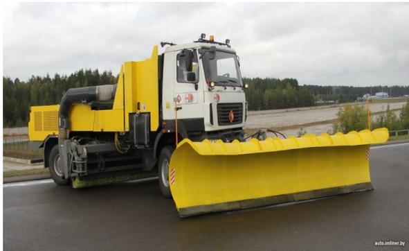
Рисунок 1.1 – Плужной снегоочиститель
