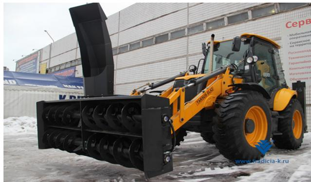
Рисунок 2 – роторный снегоочиститель Impulse SR2500
