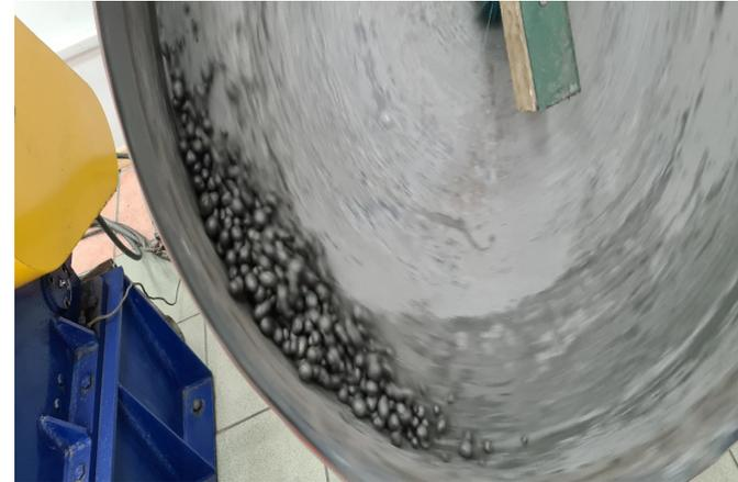
Рисунок 1 – Процесс окомковывания ферросиликомарганцевой пыли с жидким стеклом
